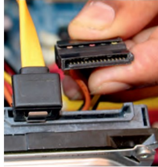
चित्र 1.20: एचडीडी में लगाने वाला 15-पिन कनेक्टर
