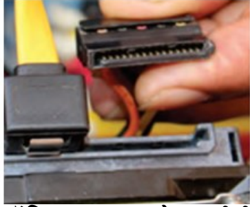
चित्र 1.47: ऑप्टिकल ड्राइव और एचडीडी से पावर केबल निकालें।
