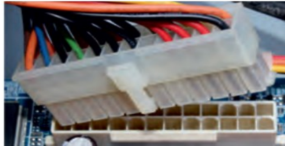
चित्र 1.18: 20-पिन एटीएक्स पावर कनेक्टर को मदरबोर्ड में लगाना
