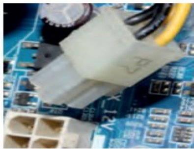
चित्र 1.45: मदरबोर्ड के पावर कनेक्टर से 4-पिन एयूएक्स पावर कनेक्टर को अनप्लग करें
