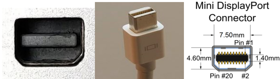
चित्र 1.43 — मिनी डिस्प्ले पोर्ट / कनेक्टर / पिनआउट आरेख
