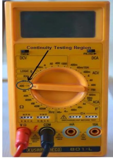
चित्र 3.16 मल्टीमीटर का उपयोग करके निरंतरता परीक्षण
