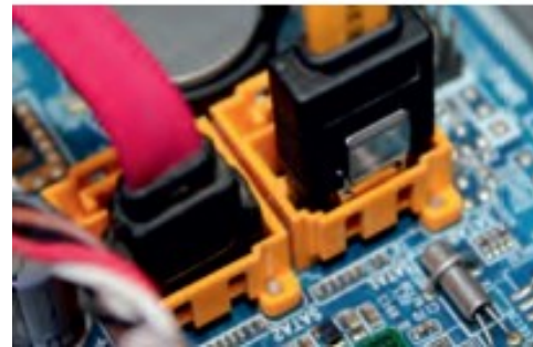
चित्र 1.46: मदरबोर्ड के पावर कनेक्टर से एसएटीए केबल को अनप्लग करें।
