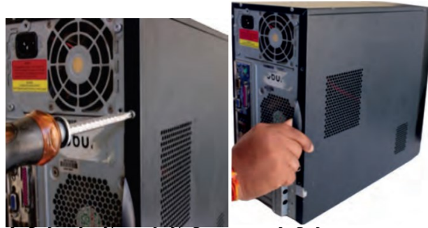
चित्र 1.1: कैबिनेट के पेंच खोलें चित्र 1.2: कैबिनेट का साइड कवर खींचें
