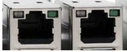
चित्र 1.47 8P – 8C टाइप कनेक्टर वाला ईथरनेट या लेन पोर्ट
