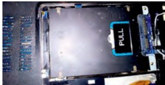
चित्र 2.8: कनेक्टर खोलें और हार्ड ड्राइव केबल को निकालें
