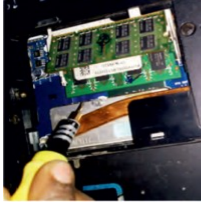
चित्र 2.11: रैम मेमोरी मॉड्यूल निकालें
